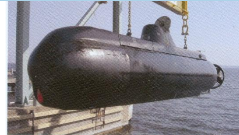
Upplöft på Berga. Den röda "burken" i fören är en aktiv-sonar.
