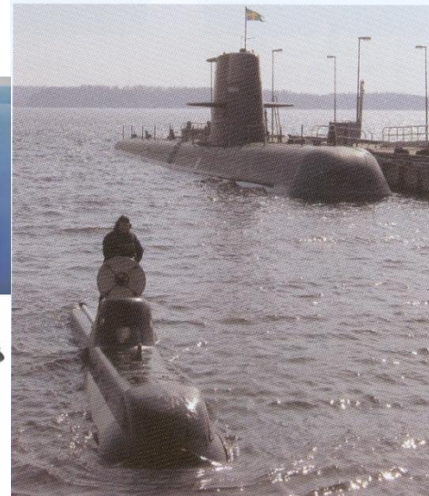
Upplöft på Berga. Den röda "burken" i fören är en aktiv-sonar.
